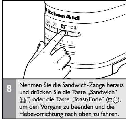
**8** Nehmen Sie die Sandwich-Zange heraus und drücken Sie die Taste „Sandwich“ (☞) oder die Taste „Toast/Ende“ (☞), um den Vorgang zu beenden und die Hebevorrichtung nach oben zu fahren.
