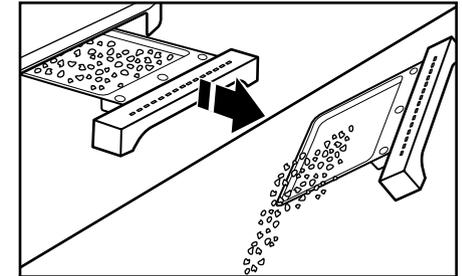
**2** Greifen Sie die Krümelschublade mittig und ziehen Sie sie heraus. Entsorgen Sie die Krümel in einen Abfalleimer. Wir empfehlen, die Krümelschublade nach jedem Gebrauch zu leeren. Die Schublade darf nur von Hand gereinigt werden.
