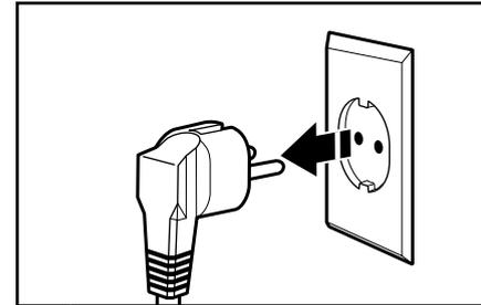
**1** Ziehen Sie vor dem Reinigen den Stecker des Toasters und lassen Sie das Gerät abkühlen.
