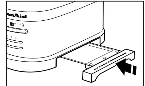
**4** Setzen Sie die Krümelschublade wieder ein. Drücken Sie dabei auf die Schublade, bis sie einrastet. Verwenden Sie den Toaster niemals ohne korrekt eingesetzte Krümelschublade.
