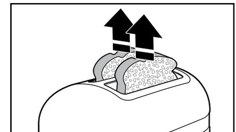
2 Wird die Speise nicht innerhalb von 3 Minuten nach Beginn des Warmhaltezyklus entfernt, wird sie angehoben; der Toaster schaltet ab.
