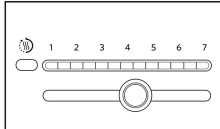
2 Stellen Sie den gewünschten Bräunungsgrad mithilfe des Bräunungsreglers ein. Schieben Sie den Regler für dunkleren Toast nach rechts und für helleren Toast nach links. Die Anzeige gibt den Bräunungsgrad von 1 (hell) bis 7 (dunkel) an.
