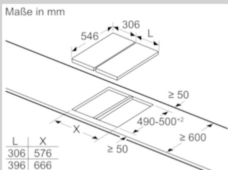
Bei der Montage von zwei oder mehreren Domino-Elementen nebeneinander sind ein oder mehrere Montagesets erforderlich (2 Elemente = 1 Montageset; 3 Elemente = 2 Montagesets usw.).
