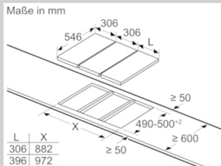
Bei der Montage von zwei oder mehreren Domino-Elementen sind ein oder mehrere Montagesets erforderlich (2 Elemente = 1 Montageset; 3 Elemente = 2 Montagesets usw.).
