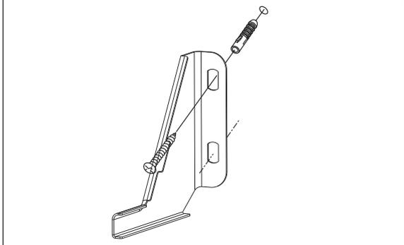
8. Bei einer massiven Wand: Stecken Sie die mitgelieferten Dübel in die Bohrlöcher. Schrauben Sie den Kippschutz mit den mitgelieferten Schrauben fest.
