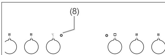
Die rote Backofen-Leuchte (8) leuchtet, sobald Sie eine Beheizungsart gewählt und die Temperatur eingestellt haben. Sie leuchtet, solange der Backofen auf- bzw. nachheizt. Wenn sie das erste Mal erlischt, ist die eingestellte Temperatur im Backofen erreicht.
