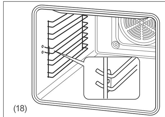
2. Um den Backblechträger (18) zu entfernen, ziehen Sie zuerst die vordere Halterung an der vorderen Seite, an der die beiden Haken mit dem angeschweißten Plättchen sind, mit einem Ruck heraus. Ziehen Sie danach die hintere Halterung des Backblechträgers heraus.
