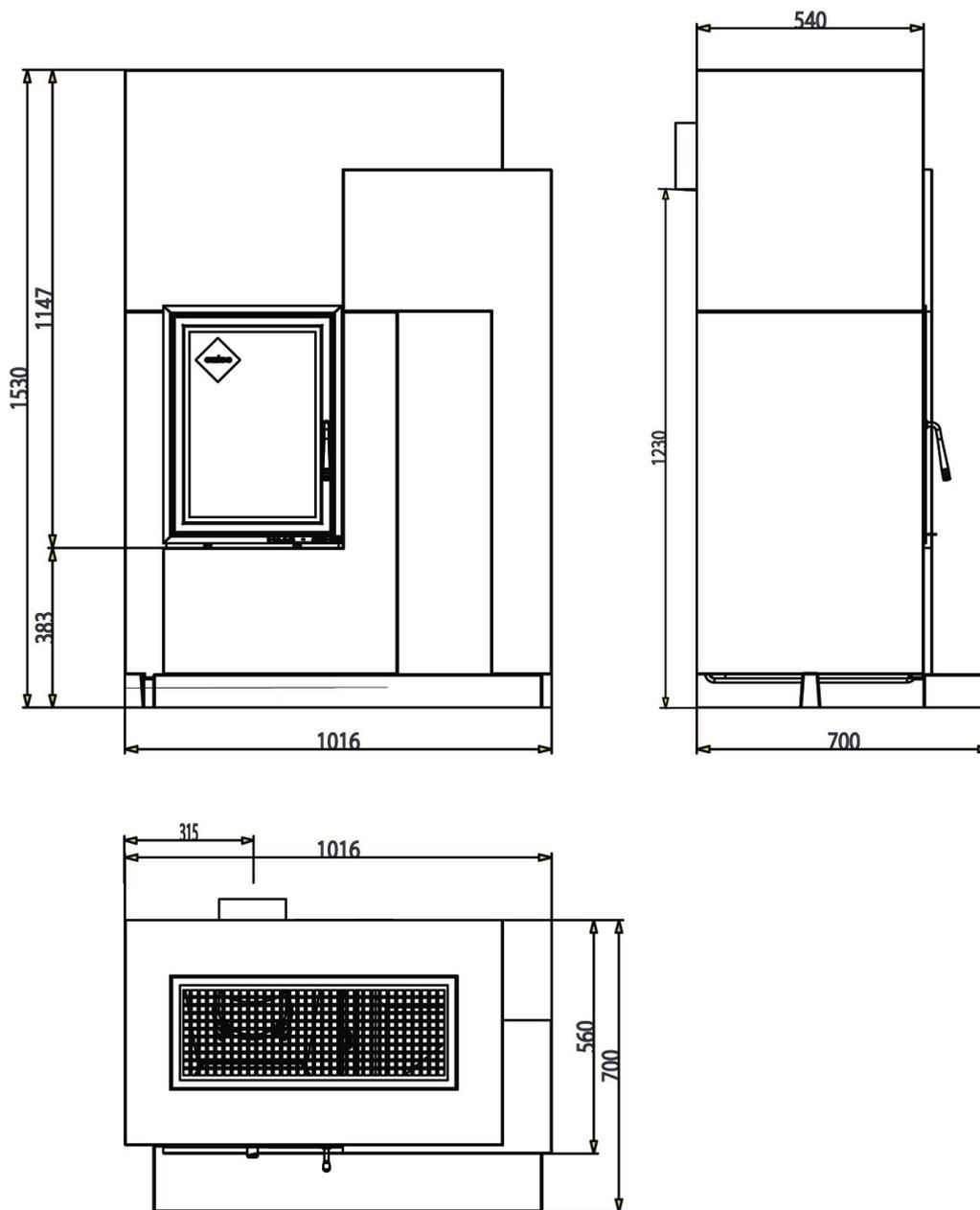
**Abbildung 12: Abmessungen**
