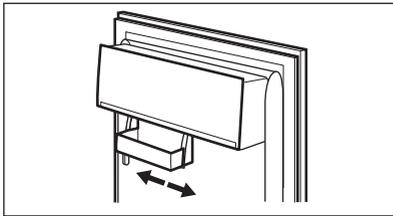
Dieses Modell ist mit einer variablen Lagerbox ausgestattet, die seitlich bewegt werden kann.
