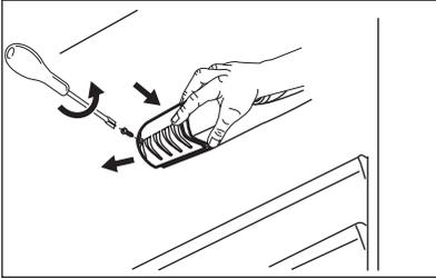
3. Ersetzen Sie die Lampe durch eine Lampe mit denselben Eigenschaften, die
