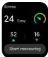
**Stress:** Durch die Messung des aktuellen Drucks kann die Uhr den Druckwert 24 Stunden am Tag aufzeichnen und anzeigen. Weitere detaillierte Informationsanalysen und Datensätze können in der APP angezeigt werden. (Der Wert dient nur als Referenz und kann nicht als medizinische Grundlage verwendet werden)
