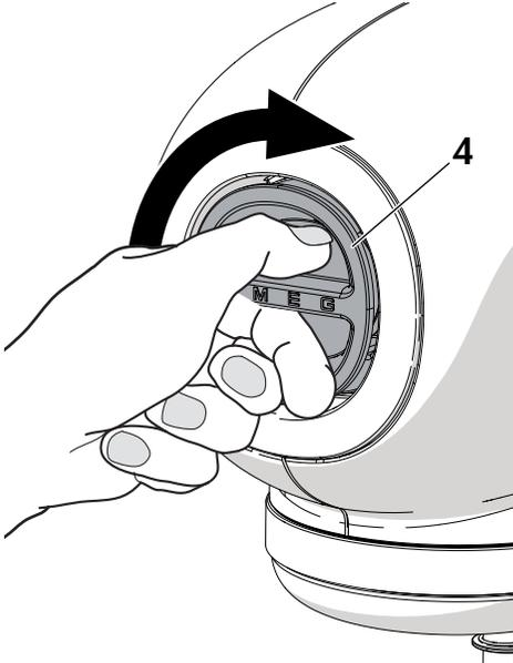
7. Nach außen hin ziehen, um die Schutzkappe zu entfernen (4).
