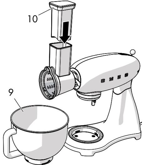
13. Um den Körper der Trommelreibe vom Anschluss der Küchenmaschine zu trennen, müssen die unter Punkt 8 angeführten Anweisungen in umgekehrter Reihenfolge durchgeführt werden.
