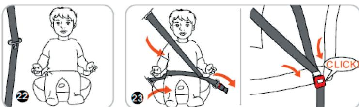
3. Τοποθετήστε το παιδικό κάθισμα αυτοκινήτου στο κάθισμα επιβάτη διασφαλίζοντας ότι είναι σταθερά πιεσμένο προς το κάθισμα του αυτοκινήτου (εικ.22).
