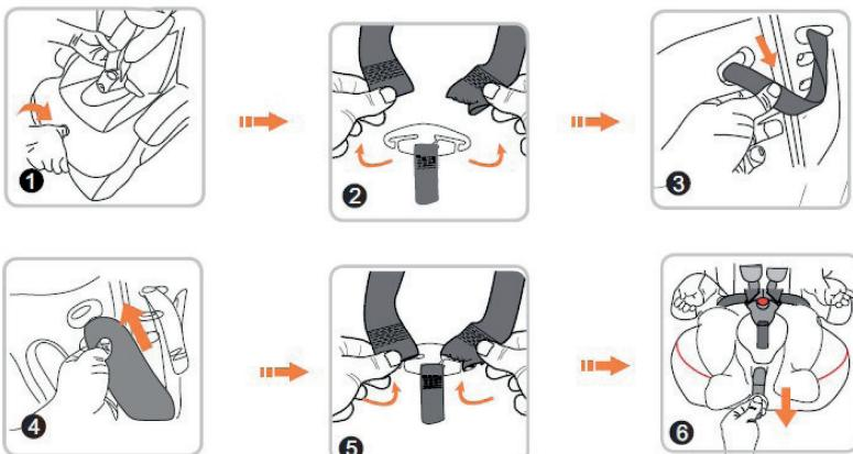
1. Presione la palanca de ajuste del arnés con una mano y tire del cinturón de hombros hacia delante con la otra mano para aflojarlo (fig. 1).
