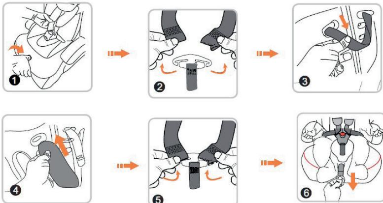
1. Appuyez sur la manette de réglage du harnais avec une main et tirez les sangles vers l'avant avec l'autre main afin de les détendre (fig.1).
