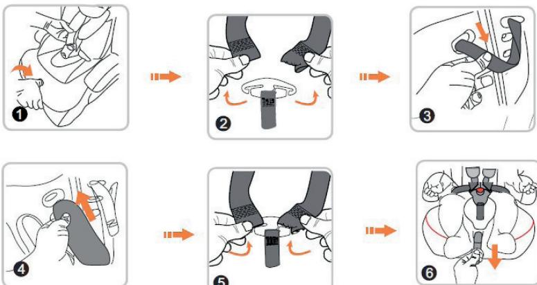
1. Z eno roko pritisnite na nastavljalec pasu, z drugo pa povlecite ramenski pas naprej, da se zrahlja (slika 1).
