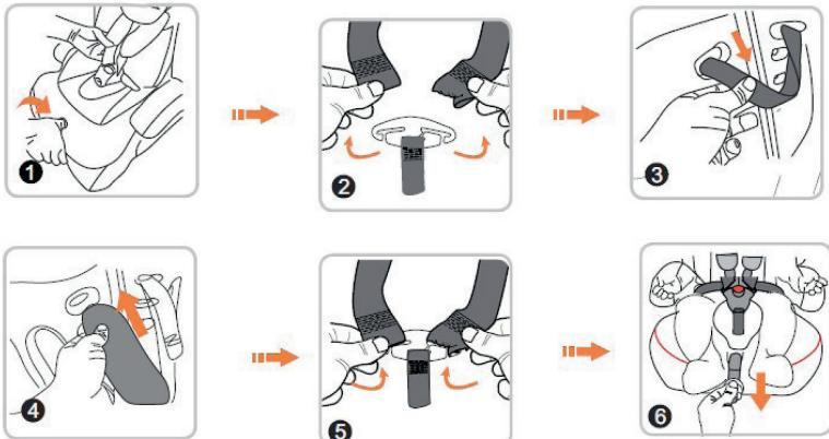
1. Drücken Sie mit einer Hand den Einstellhebel und ziehen Sie mit der anderen Hand das Schulter-Gurtzeug nach vorne, um es zu lösen (Abb. 1).
