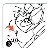
4. Aby odpiąć pasy, zwolnij blokadę, przesuwając w przód czerwony przycisk. Następnie pociągnij za klipsy na końcach pasów i rozłoż pasy na boki (rys.4).
