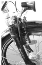
Federgabel mit Elastomer/ Federdämpfung
