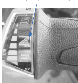
Schakelgreepmarkering 4 e versnelling
