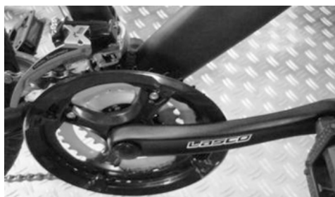
Kettingblad vooraan met derailleur
