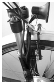
Fourche à suspension réglable avec Lock-Out (verrouillage) et possibilité d'ajustement
