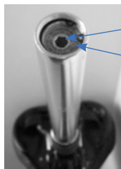
Écrou de réglage Anneau de retenue
