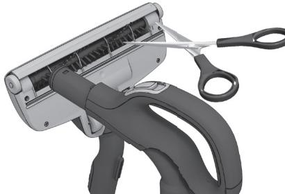
**1. Reinigung der Turbobürste.** (nur bestimmte Modelle) Düse vom Staubsaugerrohr entfernen und in der Düse verwickelte Fäden etc. zum Entfernen mit einer Schere durchschneiden. Mit dem Schlauchgriff die Düse reinigen.\*
