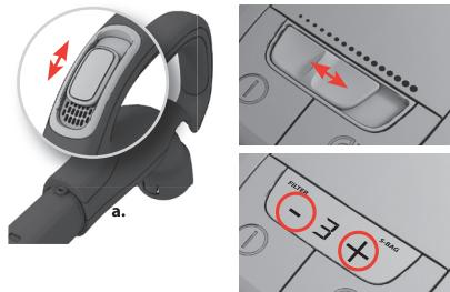
9. Saugleistung einstellen. (modellabhängig) a. Mit dem Saugleistungsregler am Griff lässt sich der Luftstrom schnell regulieren. b. Schieberegler am Staubsauger zum Einstellen der Saugleistung verwenden. c. Wippschalter + oder – am Staubsauger zum Einstellen der Saugleistung verwenden.\*
