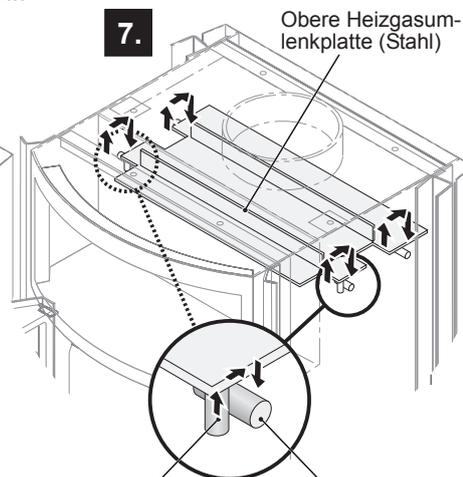
Verschiebesicherung an der oberen Heizgasumlenkplatte über den Auflagebolzen heben.
