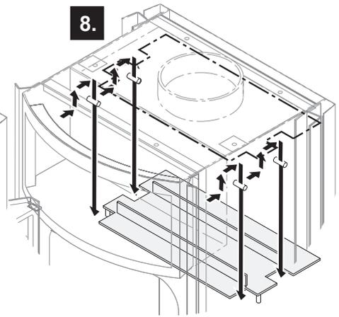
Die obere Heizgasumlenkplatte mit Hilfe der Aussparungen von den Auflagebolzen heben und entnehmen.
