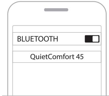
Nach dem Verbinden ertönt die Ansage „Verbunden mit <Name des Mobilgeräts>“ und das Statuslämpchen leuchtet 10 Sekunden lang blau.
