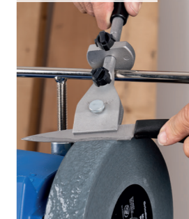
Für Messer mit einer Klinglänge von 40 mm bis 200 mm geeignet.
