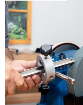
Schleift schräge Schneiden, Röhren und Hobeisen.
