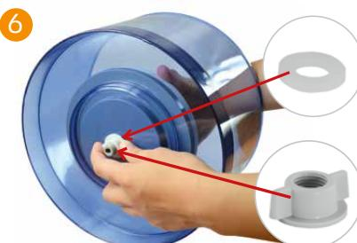
6 Faites glisser la bague d'étanchéité sur la vis du filtre sur la face inférieure et serrez l'écrou papillon.
