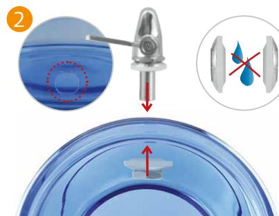
Wasserhahn mit zwei Dichtungen (trocken) jeweils innen und außen am Behälter montieren.
