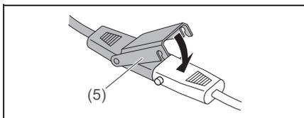
2. Klappen Sie den Riegel (5) herunter, um die Steckverbindung sicher zu verriegeln.
