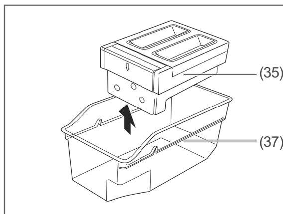
1. Entnehmen Sie den Eiswürfelbereiter (35) aus dem Eiswürfel-Auffangbehälter (37).
