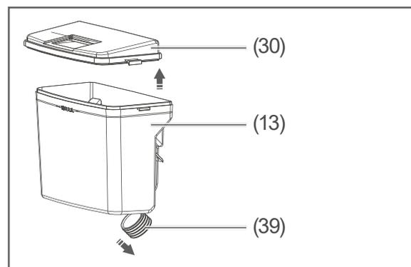
7. Nehmen Sie den Deckel (30) und den Dichtungsring (39) des Wassertanks (13) ab.
