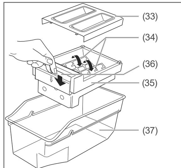
2. Drücken Sie den Auswerfer (36) des Eiwüfelbereiters in Pfeilrichtung kräftig nach unten. Achten Sie darauf, den Auswerfer ganz nach unten zu drücken. Die Eiwürfelschalen (34) drehen sich. Die Eiswürfel fallen in den Eiwüfel-Auffangbehälter (37).
