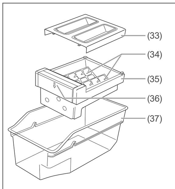
Ihr Gerät verfügt über einen Eiswürfelbereiter (35) mit einer Abdeckung (33), zwei Eiswürfelschalen (34) und einem Eiswürfel-Auffangbehälter (37). Mit Hilfe des Auswerfers (36) können Sie die Eiswürfel aus den Eiswürfelschalen lösen.
