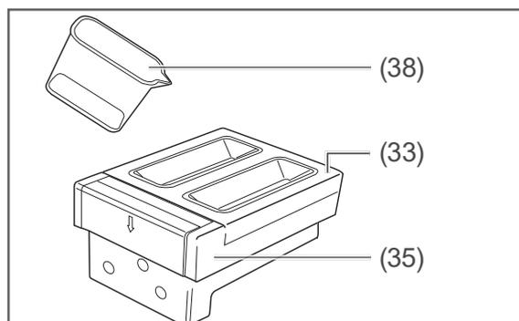
2. Füllen Sie den Messbecher (38) für je eine Eiwürfelschale (34) bis zur Markierung 55 ml mit kaltem, frischem Leitungswasser.
