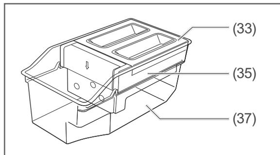
1. Nehmen Sie den Eiswürfelbereiter (35) und den Eiswürfel-Auffangbehälter (37) aus dem Gefrierbereich.
