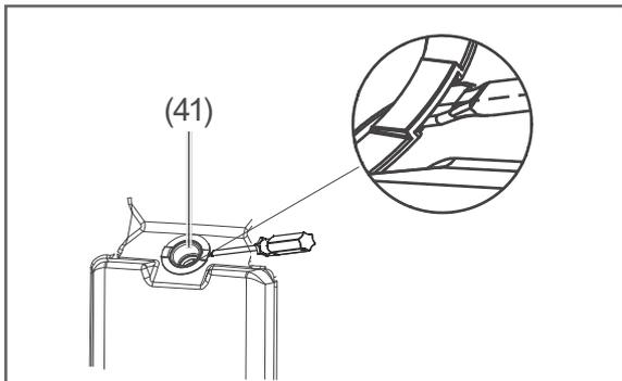
1. Hebeln Sie das Wasserventil (41) des Wasserspenders mit Hilfe eines dünnen flachen Werkzeugs etwas an.
