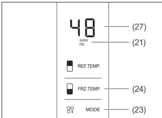
3. Um die Dauer der Funktion SUPER FRZ. auf 48 Stunden einzustellen, drücken Sie erneut den Taster FRZ.TEMP. (24). Auf dem Display erscheint „48“. Das Gerät ist 48 Stunden auf SUPER FRZ. („Schnelles Einfrieren“) eingestellt. Das Gerät schaltet nach der eingestellten Dauer aus dem SUPER FRZ.-Modus automatisch auf die zuletzt eingestellte Temperatur um.
