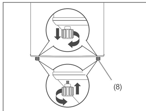
2. Gleichen Sie Unebenheiten des Untergrunds mithilfe der beiden vorderen Schraubfüße (8) aus.
