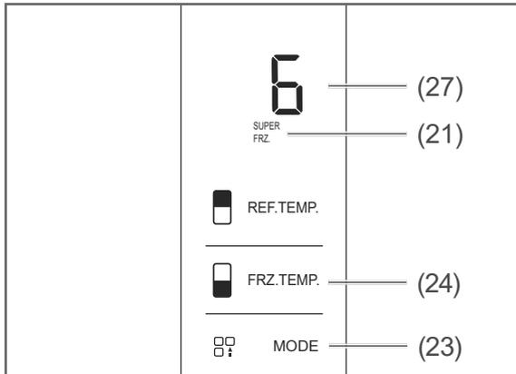
2. Drücken Sie 3 Sekunden auf den Taster FRZ.TEMP. (24). Auf dem Display erscheint „6“. Die Anzeige SUPER FRZ. (21) blinkt. Die Anzeige zeigt die Dauer der Funktion an. Das Gerät ist 6 Stunden auf SUPER FRZ. eingestellt.
