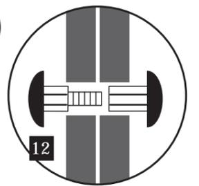
Wollen Sie 2 Schränke miteinander verbinden, bohren Sie ein 6 mm Loch in die entsprechenden Seitenteile und befestigen Sie diese mit dem Verbindungselement.
