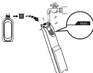
Öffnen Sie den Behälterdeckel, und füllen Sie den Behälter bis zur Markierung Max mit Leitungswasser. Wenn eine gründliche Reinigung erforderlich ist, fügen Sie dem FWB einen Flaschenverschluss der Lösung hinzu, und schließen Sie den Verschluss fest.
