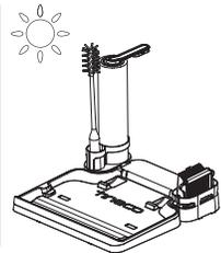
Verwenden Sie das Reinigungswerkzeug, um Haare und Verschmutzungen zu entfernen, die sich um die Bürstenrolle gewickelt haben, und spülen Sie sie mit Wasser ab. Setzen Sie die Bürstenrolle wieder in den Zubehörhalter ein, und lassen Sie sie vollständig trocknen, bevor Sie sie wieder in das Gerät einsetzen.
