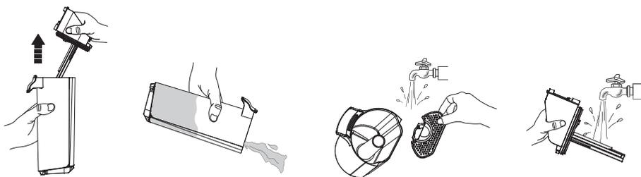
Wenn der Deckel des Schmutzwasserbehälters und der Filter im Inneren verstopft sind, entfernen Sie Behälterdeckel und Filter und spülen Sie beide Teile mit Wasser ab.
