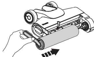
Setzen Sie die Bürstenrolle wieder ein, indem Sie das Bürstenrollenende in die rechte Seite der Halterung einsetzen und dann die Lasche der Rolle an der magnetischen SchlieÙe auf der linken Seite befestigen, um sie zu verriegeln.
