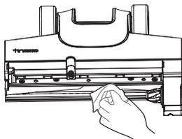
Entfernen Sie Haare und Schmutz mit einem Papiertuch oder einem feuchten Tuch aus der Bürstenrollenkammer und der Öffnung.
