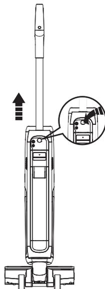
Um den Griff zusammenzusetzen, setzen Sie ihn in das Gerät ein, bis er hörbar einrastet.
