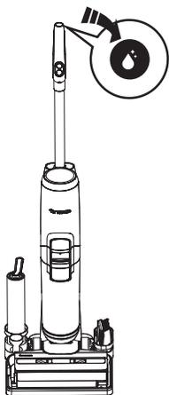
1. Stellen Sie das Gerät auf die Ablage und schließen Sie es an. Drücken Sie die Selbstreinigungstaste und starten Sie den Vorgang.
