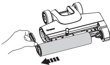
Greifen Sie die Bürstenrollenlasche und entfernen Sie die Bürstenrolle, indem Sie sie herausziehen.
