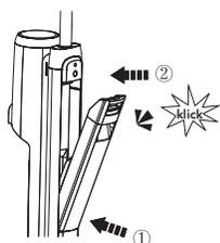
Setzen Sie den Behälter wieder in das Gerät ein. Wenn Sie den Vorgang korrekt ausgeführt haben, sollten Sie ein „klick“ hören.
