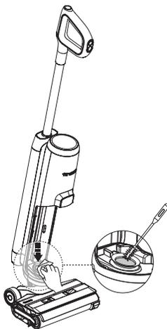
Entfernen Sie den Schmutzwasserbehälter und reinigen Sie den Schmutzwasseranschluss mit einem feuchten Tuch oder dem Reinigungswerkzeug, um Blockierungen zu vermeiden.
