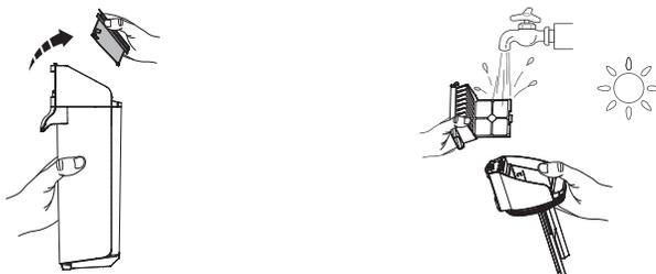
Fassen Sie den vertieften Bereich auf jeder Seite des Trockenfilters und ziehen Sie ihn nach oben. Spülen Sie ihn unter fließendem Wasser ab. Der Filter muss vollständig trocken sein, bevor Sie ihn wieder in den Deckel des SWB einsetzen.
