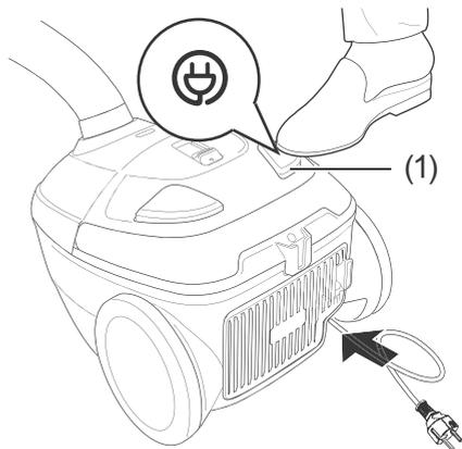
3. Treten Sie zum Aufwickeln des Netzkabels auf den Fußschalter für Kabelaufwicklung (1). Halten Sie dabei das Netzkabel in der Hand, um einen eventuellen „Peitscheneffekt“ zu verhindern.
