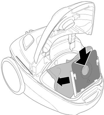
5. Schieben Sie einen neuen Staubbeutel in den Staubbeutelhalter.
