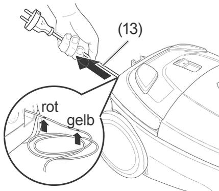
1. Ziehen Sie das Netzkabel (13) heraus, bis die gelbe Markierung auf dem Netzkabel sichtbar wird.
