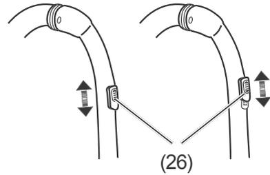
Bei Bedarf können Sie die Saugkraft mithilfe des Nebenluftventils (26) weiter verringern. Die Abdeckung des Nebenluftventils lässt sich stufenlos verschieben.
