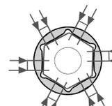
Einsätze mit Flanc-Drive System: der Antrieb erfolgt über die Seitenflächen des Schraubensechskants
