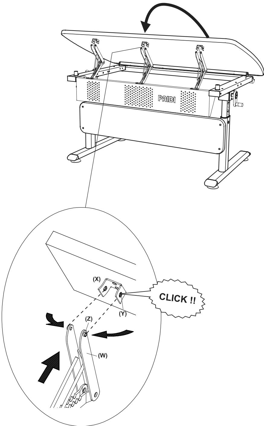
**DE:** Rasterschere (W) auf das Anschraubteil (X) aufschieben, so dass die Bohrungen (Y) in die Bolzen (Z) einrasten.
