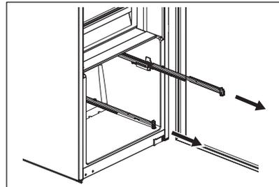
2. Setzen Sie den hinteren Teil der Schublade (1) auf die Schienen.
