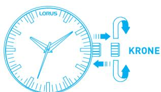
Ziehen Sie die Krone heraus, wenn sich der Sekundenzeiger auf der 12-Uhr-Position befindet. Der Sekundenzeiger bleibt stehen.
