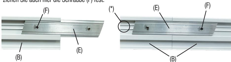
**Achtung:** Verbinden Sie zuerst die Profile mit den Profilverbindern und setzen Sie erst danach mit der weiteren Montage fort.
