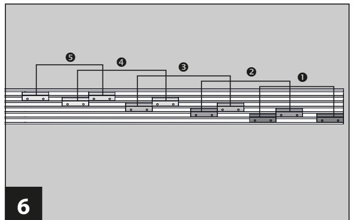
6 Schematische Darstellung der fertig überlappend eingeschobenen Lamellen.
