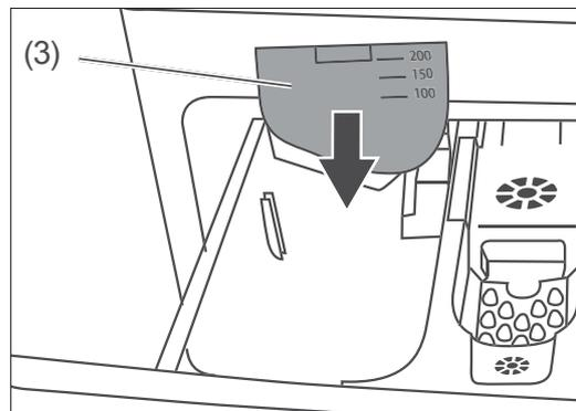
Wenn Sie das Einfüllfach II mit Flüssigwaschmittel benutzen, bringen Sie zuvor die Trennwand für Flüssigwaschmittel (3) wie im Bild gezeigt an.
