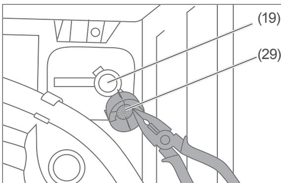
10. Ziehen Sie das Sieb (29) z. B. mit einer Pinzette oder Zange aus dem Anschlussstutzen für den Wasser-Zulaufschlauchs (19) heraus.
