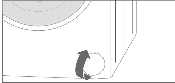
10. Setzen Sie die Blende so ein, das die Öffnung nach oben zeigt und drücken Sie sie fest.
