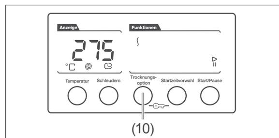
Haben Sie ein reines Trockenprogramm oder ein kombiniertes Wasch-/Trockenprogramm gewählt, erscheint auf dem Display sofort die Anzeige der Trocknungsoption.
