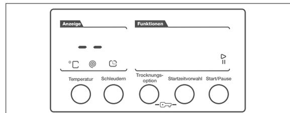
Nach „400“ ist der nächste Schritt „--“. Die Schleuderfunktion ist jetzt ausgeschaltet. Wählen Sie diese Einstellung, wenn die Wäsche am Ende des Programms nicht geschleudert werden soll.
