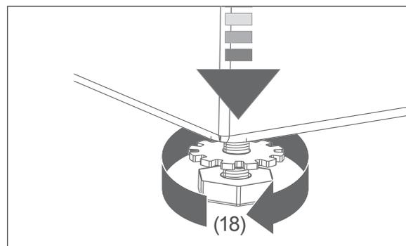
1. Lösen Sie die Kontermutter eines Schraubfußes (18) auf der Geräteunterseite.
