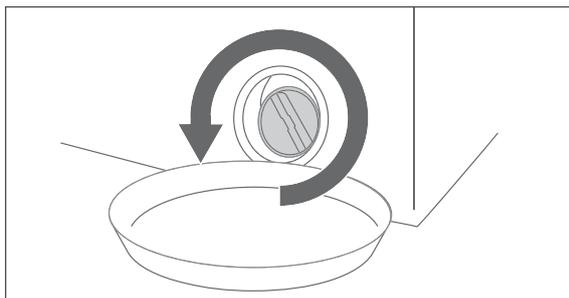
5. Drehen Sie die Fremdkörperfalle gegen den Uhrzeigersinn nur so weit auf, bis das Wasser abfließt. Leeren Sie zwischendurch ggf. den Auffangbehälter.
