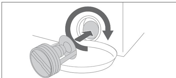
8. Setzen Sie die Fremdkörperfalle wieder ein. Achten Sie darauf, dass der Griff sich dabei in waagerechter Position befindet.
