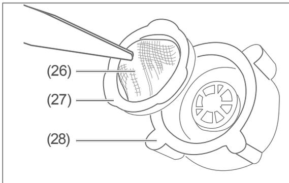
4. Ziehen Sie das Sieb (26) mit der Dichtung (27) z. B. mit einer Pinzette oder Zange aus der Überwurfmutter (28) heraus.
