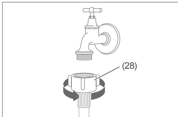
2. Befestigen Sie das andere Ende des Wasser-Zulaufschlauchs handfest am Wasserhahn. Drehen Sie dazu die Überwurfmutter (28) im Uhrzeigersinn.
