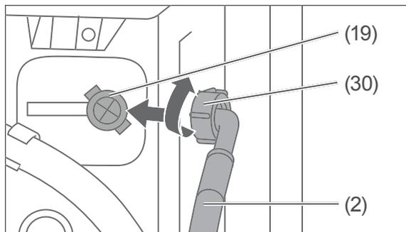
1. Schrauben Sie den Wasser-Zulaufschlauch (2) handfest am Anschlussstutzen (19) fest. Drehen Sie dazu die Überwurfmutter (30) im Uhrzeigersinn.
