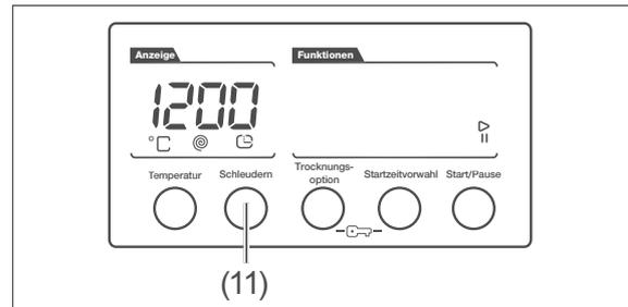
2. Drücken Sie die Taste „Schleudern“ (11). Auf dem Display (7) erscheint die Schleuderdrehzahl, mit der das Programm standardmäßig abläuft. Sie haben nun 3 Sekunden Zeit, die gewünschte Schleuderdrehzahl einzustellen.
