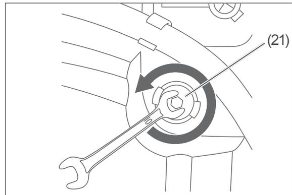
1. Lösen Sie die Schrauben der Transportsicherungen (21) mit einem 10er-Schraubenschlüssel.
