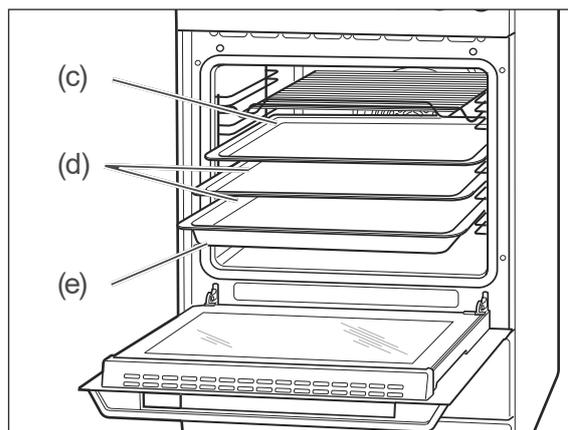
Die mitgelieferten Backbleche (d) und die Fettpfanne (e) haben eine schräge Kante. Nach dem Einschieben sollte diese Kante vorne liegen. Der Grillrost (c) muss wie abgebildet eingeschoben werden.
