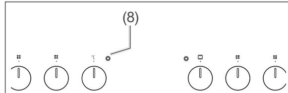
Die rote Backofen-Leuchte (8) leuchtet, sobald Sie eine Beheizungsart gewählt und die Temperatur eingestellt haben. Sie leuchtet, solange der Backofen auf- bzw. nachheizt. Wenn sie das erste Mal erlischt, ist die eingestellte Temperatur im Backofen erreicht.
