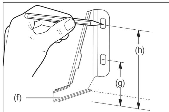
4. Halten Sie den Kippschutz (f) auf der Linie so an die Wand, dass die Seite mit den Löchern plan an der Wand aufliegt und der hervorstehende Schenkel in den Schlitz am Herd passt.
