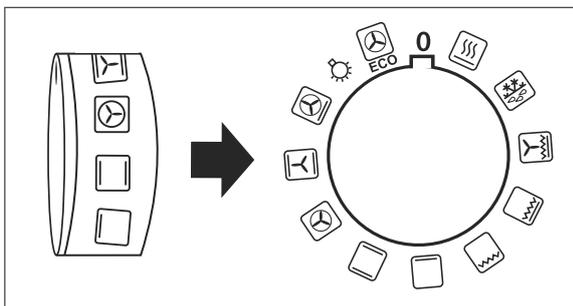
Mit dem Funktionsschalter schalten Sie den Backofen ein und wählen die Beheizungsart aus. Die Backofenbeleuchtung wird eingeschaltet.
