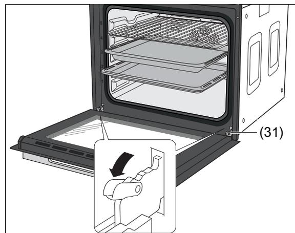
2. Klappen Sie an beiden Seiten die Bügel (31) ganz nach vorne. Nehmen Sie gegebenenfalls einen Schraubendreher zu Hilfe.
