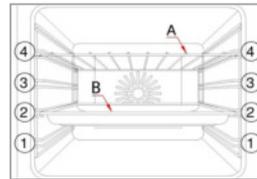
Im Garraum befinden sich Gitter 1-4 zum Einschieben des Zubehörs A+B.
