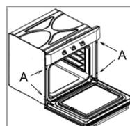
Befestigungslöcher (A) werden nach dem Öffnen der Ofentür links und rechts im Rahmen sichtbar.
