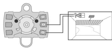
**ANSCHLUSS AN ZWEI TORANTRIEBE (Tastbetrieb)**
