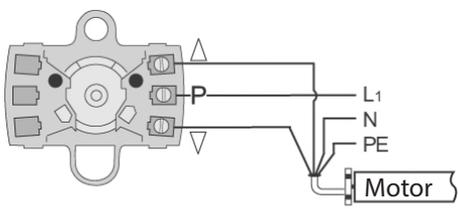
**ANSCHLUSS AN EINEN TORANTRIEB (Tastbetrieb)**
