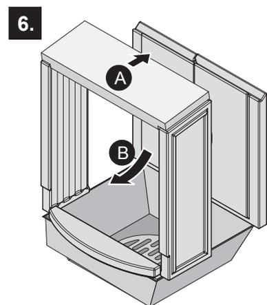
Die Heizgasumlenkplatte nach hinten schieben **A** und entnehmen **B**.
