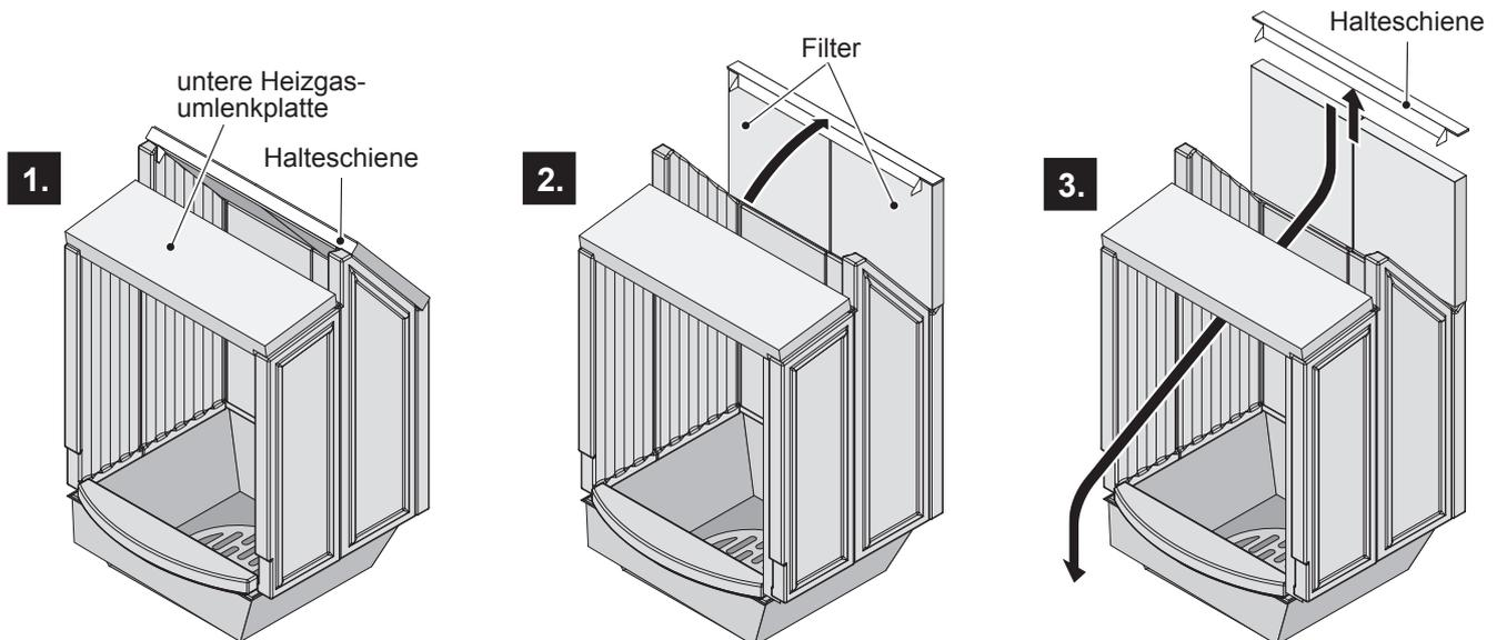
Halteschiene mit den Filtern nach oben schwenken.
