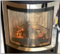
Sekundärluft: Komplett geöffnet ("MAX")
