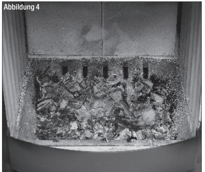
Lassen Sie diese Holzaufgabe mit geöffneten Verbrennungsluftreglern herunterbrennen, bis eine Grundglut vorhanden ist (Abb. 4). Je nach Holzgüte, Schornsteinzug und Witterung dauert diese Verbrennungsphase unterschiedlich lange. Legen Sie jetzt zwei weitere Holzstücke parallel zur Feuerraumscheibe auf und verschließen die Feuerraumtür (Abb. 5).
