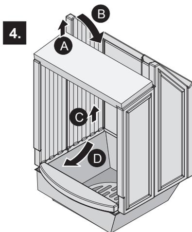
Die Heizgasumlenkplatte links hinten anheben **A** und die seitliche hintere, linke Feuerraumwand oben nach innen schwenken **B**, anheben **C** und entnehmen **D**.
