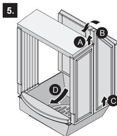
Die Heizgasumlenkplatte rechts hinten anheben **A** und die seitliche hintere rechte Feuerraumwand oben nach innen schwenken **B**, anheben **C** und entnehmen **D**.
