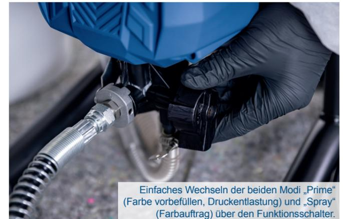
Einfaches Wechseln der beiden Modi „Prime“ (Farbe vorbefüllen, Druckentlastung) und „Spray“ (Farbauftrag) über den Funktionsschalter.
