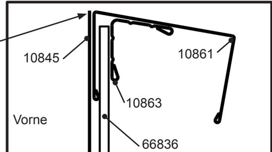
**HINWEIS** Achten Sie beim Festziehen der Maschinenschrauben darauf, dass die Einfassung stets mit den Fensterstützen außen fluchtet.
