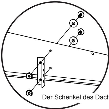
Der Schenkel des Dachträgerwinkels muss wie gezeigt zur Mitte des Giebels zeigen.
