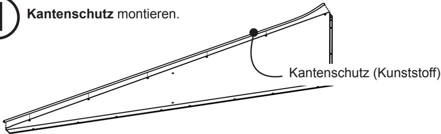
Der Kantenschutz MUSS die Giebelkante abdecken.
