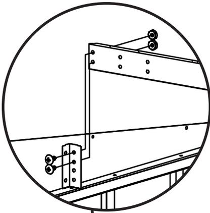
Montieren Sie den Dachträger durch die zwei (2) oberen Löcher an der Giebelverstärkung.
