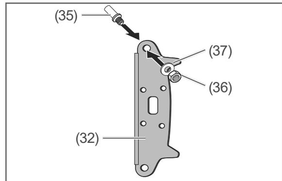
3. Drehen Sie das untere Scharnier (32) um, und schrauben Sie den Scharnierbolzen (35) wieder an.
