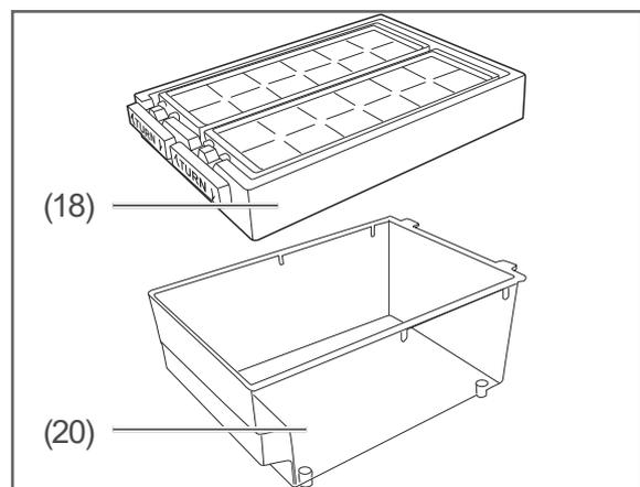
3. Nehmen Sie den Eiswürfelbereiter (18) vom Vorratsbehälter (20) ab, und entnehmen Sie die Eiswürfel. Benutzen Sie dazu am besten eine Eisschaufel (nicht im Lieferumfang enthalten), um Kälteverletzungen zu vermeiden.
