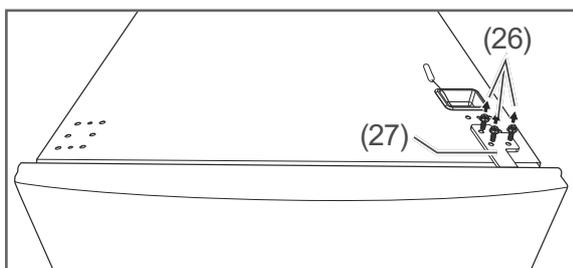
3. Lösen Sie die Schrauben (26) am oberen Scharnier (27), und nehmen Sie das Scharnier ab.
