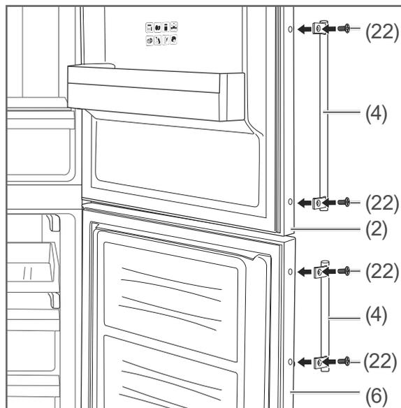
2. Schrauben Sie mit den mitgelieferten Schrauben (22) den längeren Türgriff (4) an der Kühlbereichstür (2) und den kürzeren Türgriff an der Gefrierbereichstür (6) fest.
