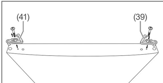
4. Lösen Sie die Schraube am Kunststoffeinsatz (41) für die Gefrierbereichstür, und nehmen Sie den Kunststoffeinsatz ab.
