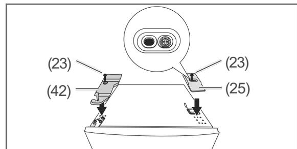
8. Setzen Sie die linke Abdeckung (42) auf, und schrauben Sie sie mit einer Schraube (23) fest.
