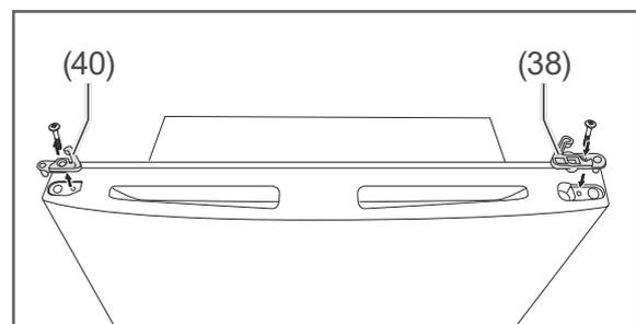
2. Lösen Sie die Schraube am Kunststoffeinsetzung (40) der Kühlbereichstür, und nehmen Sie den Kunststoffeinsetzung ab.
