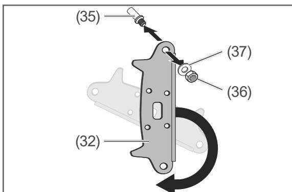
2. Lösen Sie mithilfe des 10er Schraubenschlüssels und einer Zange die Mutter (36) des Scharnierbolzens (35) am unteren Scharnier (32), und nehmen Sie sie zusammen mit dem Sprengring (37) ab.
