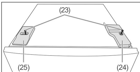
1. Lösen Sie mit dem Kreuzschlitzschraubendreher die Schrauben (23) der Abdeckungen (24) und (25).
