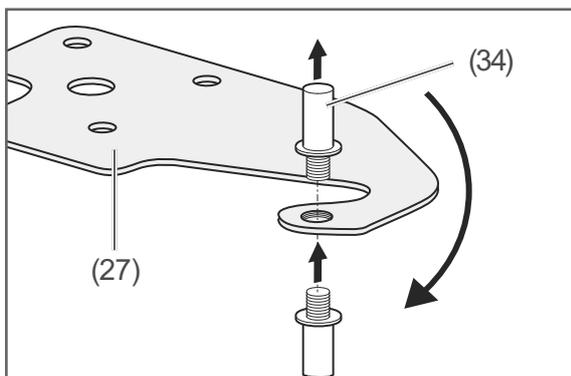
1. Drehen Sie, am besten mit einer Zange, den Scharnierbolzen (34) des oberen Scharniers (27) heraus, und drehen Sie ihn auf der anderen Seite wieder hinein.
