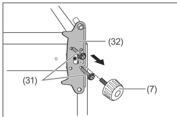
8. Lösen Sie die Schrauben (31) am unteren Scharnier (32), drehen Sie den rechten Schraubfuß (7) heraus, und nehmen Sie das Scharnier ab.
