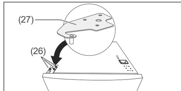
7. Setzen Sie das obere Scharnier (27) ein, und schrauben Sie es mit den Schrauben (26) fest.
