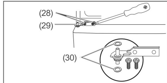
5. Schrauben Sie mit den Schrauben (28) das mittlere Scharnier (29) fest. Benutzen Sie ggf. die beiden Unterlegscheiben (30), um die Abstände zwischen dem Scharnier und den Türen zu regulieren.
