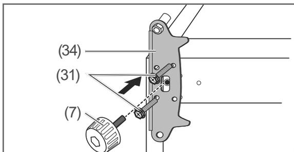
2. Schrauben Sie mit den beiden Schrauben (31) das untere Scharnier (32) links an, und drehen Sie den Schraubfuß (7) wieder ein.
