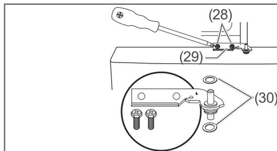
5. Lösen Sie die Schrauben (28) am mittleren Scharnier (29), und nehmen Sie das mittlere Scharnier ab. Bewahren Sie die beiden Unterlegscheiben (30) auf.
