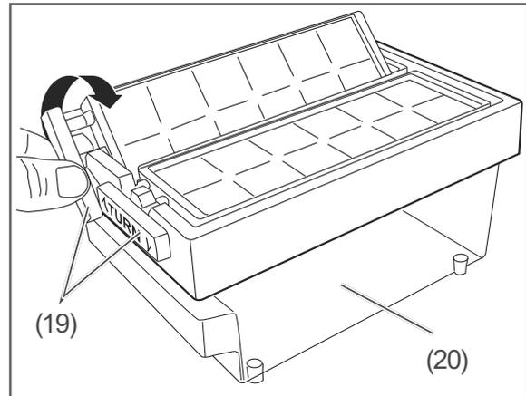
2. Zum Entnehmen von Eiswürfeln drehen Sie die Hebel (19) im Uhrzeigersinn. Die Eiswürfel (17) werden so umgedreht und gleichzeitig etwas verdreht, und die Eiswürfel fallen in den Vorratsbehälter (20).
