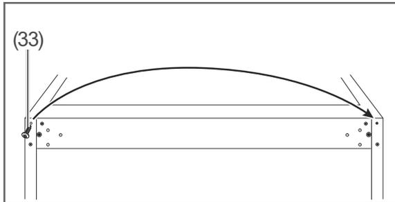
10. Lösen Sie die Schraube (33), und setzen Sie sie an der gegenüberliegenden Seite wieder ein.
