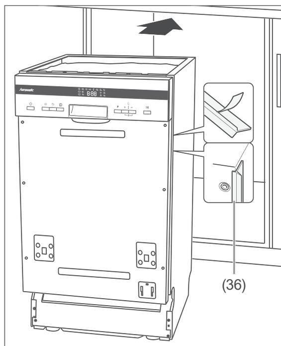
5. Entfernen Sie die Schutzfolien von den seitlichen Abschlussprofilen (36).
