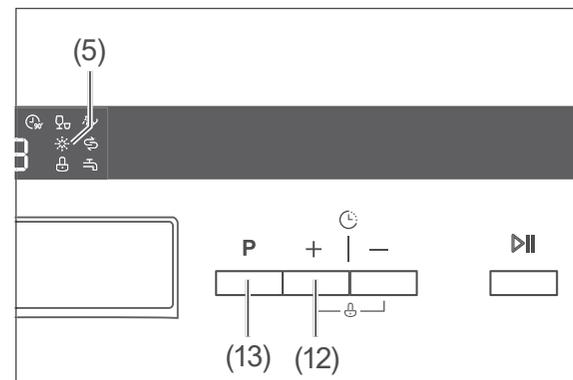
2. Drücken Sie innerhalb von 60 Sekunden nach dem Einschalten 5 Sekunden lang die Taste **P** (13).
