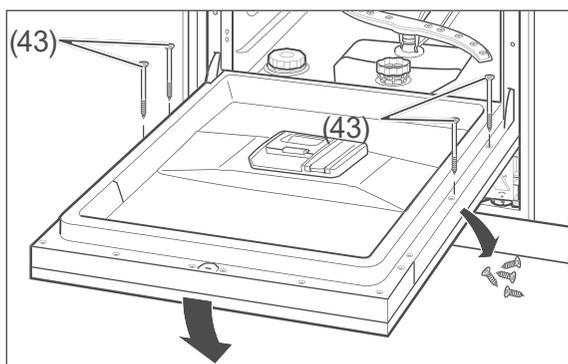
17. Entfernen Sie die 4 Schrauben an der Innenseite der Tür. Schrauben Sie die Möbelfrontplatte an diesen Positionen mithilfe der beiliegenden 4 Schrauben (43) fest. Die Möbelfrontplatte ist damit montiert.
