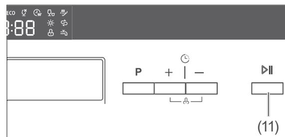
1. Drücken Sie die Taste ►|| (11), um das Spülprogramm zu unterbrechen. Das Programmsymbol leuchtet nun dauerhaft.
