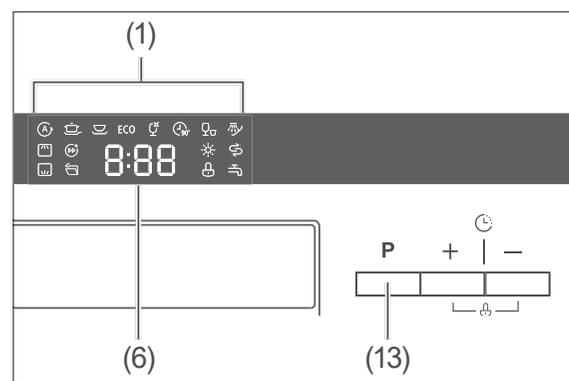
2. Drücken Sie die Taste **P** (13) so oft, bis das Display das gewünschte Programmsymbol (1) und die Programmdauer (6) anzeigt.
