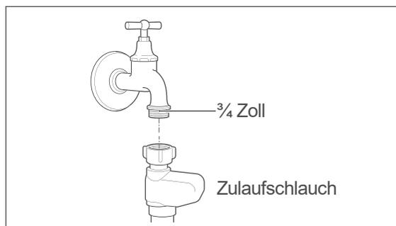
Für die Wasserversorgung benötigen Sie einen Wasserhahn mit einem 3/4 Zoll Schraubanschluss.
