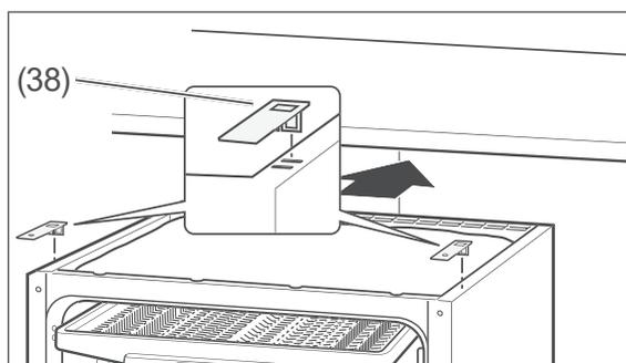
4. Stecken Sie beide Montagewinkel (38) in die vorderen Schlitze an der oberen Seite des Geschirrspülers, um später den Geschirrspüler an die Arbeitsplatte anschrauben zu können.
