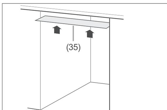
3. Kleben Sie die beiliegende Schutzfolie für Kondenswasser (35) auf die Unterseite der Arbeitsplatte. So vermeiden Sie Schäden an der Arbeitsplatte aufgrund heißer Dämpfe, die bei geöffneter Gerätetür aus dem Geschirrspüler strömen.
