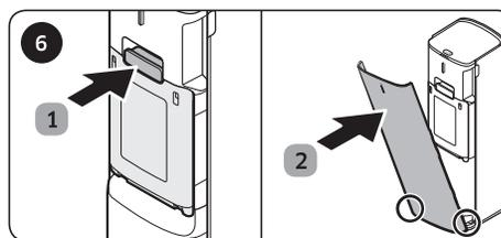
Nach dem Tauschen des Staubbeutels bauen Sie die Reinigungsstation in umgekehrter Reihenfolge wieder zusammen.
