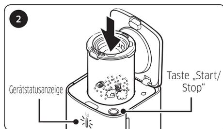
Setzen Sie den Staubbehälter in die Reinigungsstation ein. Der Staub wird automatisch ausgeworfen.
