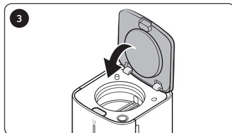
Wenn die Reinigungsstation vollständig zum Stillstand gekommen ist, ziehen Sie den Staubbehälter heraus und schließen Sie die Reinigungsstation wieder. Dazu drücken Sie fest auf die obere Verkleidung.
