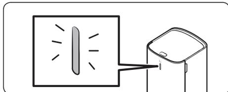
\* Tauschen Sie den Staubbeutel aus, wenn die Gerätstatusanzeige auf Rot wechselt.
