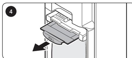
Ziehen Sie den [PULL]-Hebel diagonal heraus und entnehmen Sie den Staubbeutel.
