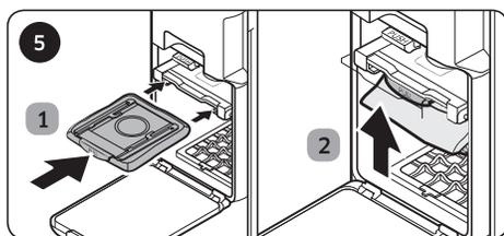
Drücken Sie einen neuen Staubbeutel nach hinten hinein und drücken Sie den [PULL]-Hebel so fest nach oben, dass Sie ein Klicken hören.
