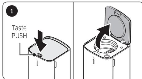
Drücken Sie auf den mit **[PUSH]** beschrifteten Hebel an der Oberseite der Reinigungsstation.
