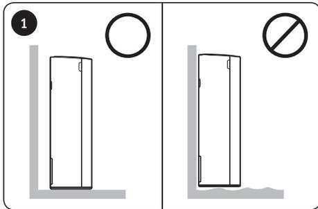
Da sich der Auslass auf der Rückseite des Geräts befindet, dürfen Sie es nicht zu dicht an die Wand aufstellen. Lassen Sie 10 cm Abstand zwischen Wand und Gerät. Stellen Sie das Gerät auf einen stabilen Untergrund.
