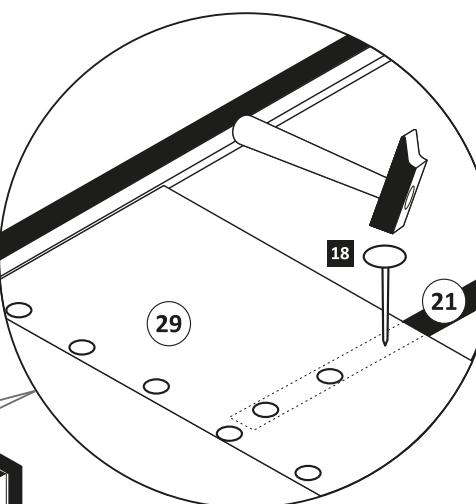
Bitte zeichnen Sie die Position der Mittelwand und des Unterbodens auf der Rückwand **29** genau an, bevor Sie diese mit den Rückwandnägeln **18** befestigen!
