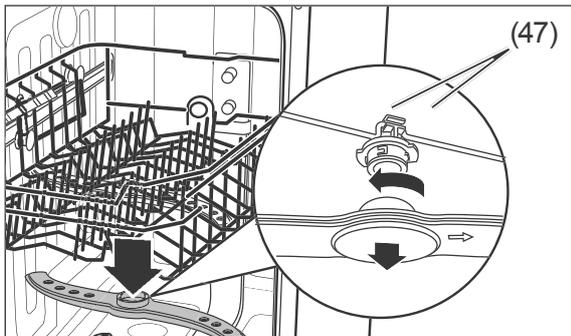
3. Der obere Sprüharm ist mit einem Bajonett-Verschluss befestigt. Zum Abnehmen des Sprüharms halten Sie die beiden gezackten Bajonettgriffe (47) fest und drehen Sie den Sprüharm im Uhrzeigersinn ab.
