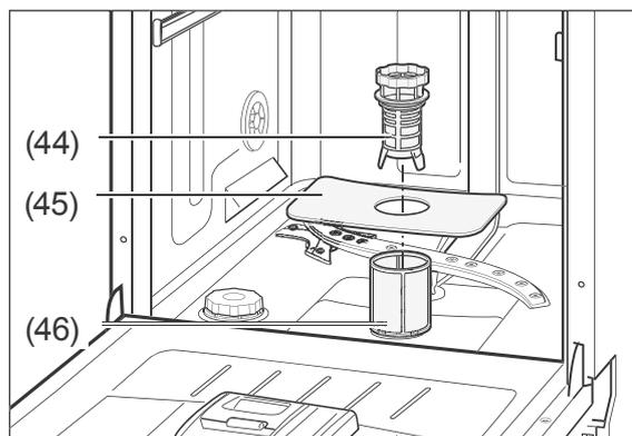
Überprüfen Sie nach jedem Spülgang das Grobsieb (44), das Hauptsieb (45) und das Feinsieb (46) und entfernen Sie ggf. Speisereste und Fremdkörper.
