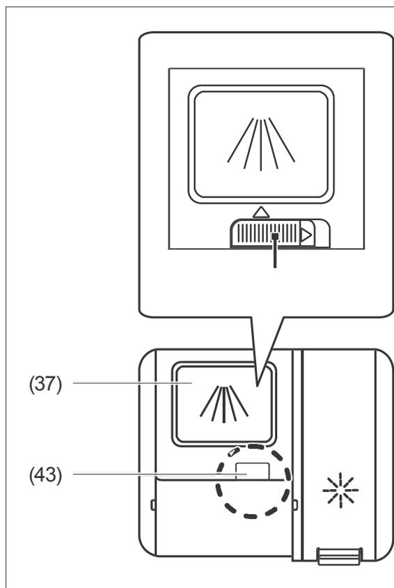
1. Schieben Sie den Verschluss (43) der Spülmittelkammer (37) zur Seite. Der Deckel springt auf.
