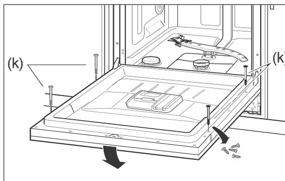
17. Entfernen Sie die 4 Schrauben an der Innenseite der Geschirrspülertür. Schrauben Sie die Möbelfrontplatte an diesen
