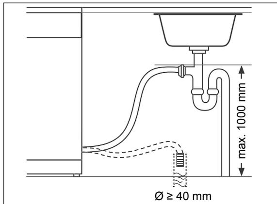
Sie können den Auslass des Abflussschlauchs auf zwei verschiedene Weisen anschließen lassen:
