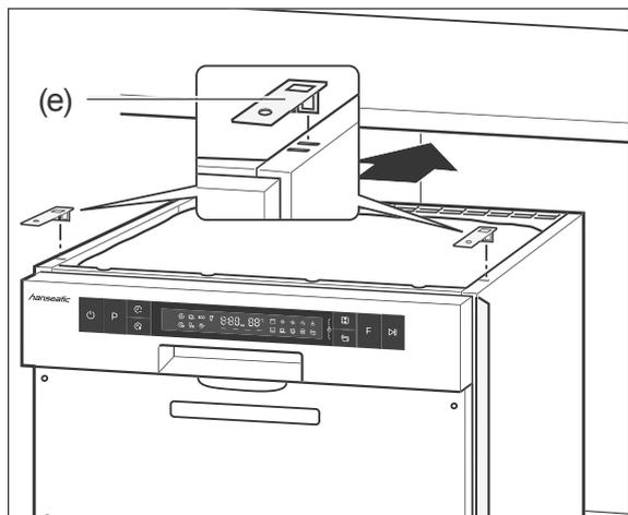
4. Stecken Sie beide Montagewinkel (e) in die vorderen Schlitzte an der oberen Seite des Geschirrspülers, um später den Geschirrspüler an die Arbeitsplatte anschrauben zu können.
