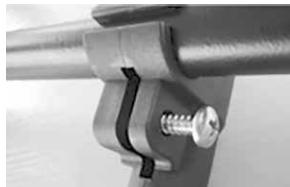
Inserire le viti a croce nei fori del dispositivo di bloccaggio sulle traverse. Non stringere ancora le viti.
