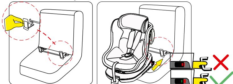
Schritt 1: Installieren Sie die ISOFIX-Führungshülsen an den unteren ISOFIX-Verankerungen.
