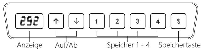
Die ganze Fernsteuerungsoberfläche ist eine Touch-Konsol. Falls für 30 Sekunden nichts gedrückt wird, sperrt sich der Bildschirm und die Speichertasten 1 - 4 sind gesperrt. Für erneute Nutzung, den Auf oder drücken, sodass der Bildschirm sich erhellt und genutzt werden kann.
