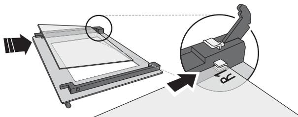
**4.** Die obere Ecke wieder anbringen: ein Klick bestätigt die richtige Positionierung. Sicherstellen, dass die Dichtung vor Wiedereinbau der Tür befestigt wird.
