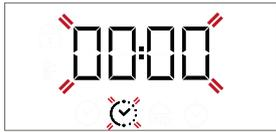
⊕ oder ⊖ zum Einstellen der gewünschten Garzeit verwenden, anschließend ☑ zur Bestätigung drücken. Die Funktion durch Drehen des *Thermostatreglers* auf die gewünschte Temperatur aktivieren: Es ertönt ein akustisches Signal und das Display zeigt an, dass der Garvorgang beendet ist.
