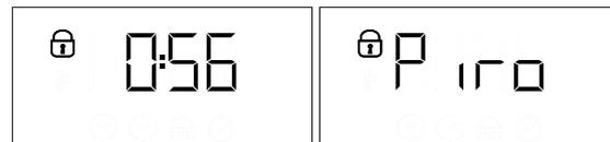
Bitte beachten: Es kann ausschließlich die Abschaltzeit dieser Funktion programmiert werden. Die Dauer wird automatisch auf 120 Minuten eingestellt.
