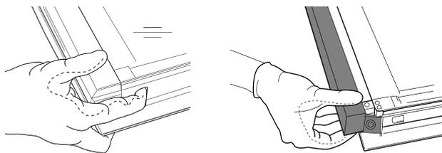
**2.** Die Glasscheiben mit beiden Händen anheben und festhalten, diese entfernen und vor der Reinigung und auf eine weiche Fläche legen.
