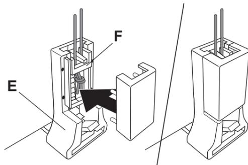
19. Kontrollieren Sie, dass die Schnüre vollständig hinter der Abdeckung der Halteclips **E** verschwinden.
