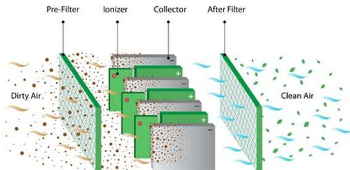
Die Partikel in der Luft werden mit bis zu 8.000 Volt aufgeladen und durch das Metall des Filters magnetisch angezogen
