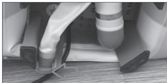
3. Schrauben Sie die Filterpatrone durch Drehen im Uhrzeigersinn auf den Wassereinlass der Whirlpoolwand und setzen Sie die Husse auf die Filterkartusche. Diese Husse hält Haare und grobe Schmutzpartikel zurück, die sonst Ihre Filterkartusche schneller verunreinigen würden.
