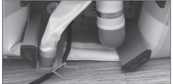
3. Schroef het filterpatroon erop door dit met de klok mee vast te draaien op de waterinlaat in de wand van de SPA en schuif de hoes over het filterpatroon. Deze hoes houdt haren en grove vuildeeltjes tegen waar het filterpatroon anders eerder door vervuild zou raken.
