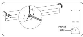
2.1 Drücken Sie **mit** dem Stift am Motor kurz auf die Programmtaste.
