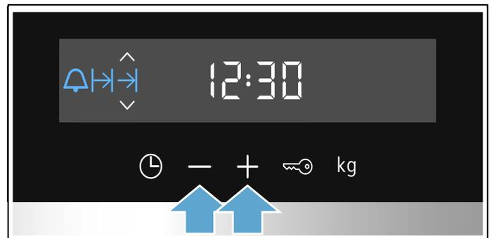
Nach wenigen Sekunden übernimmt das Gerät die Einstellungen. Im Display steht die Endezeit. Sobald das Gerät startet, läuft die Dauer ab.
