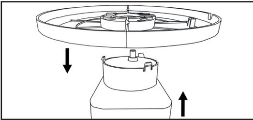
3. Nehmen Sie die 4 Schraube (ST3×8) und schrauben Sie den Standfuß an die Geräteunterseite an. Nach dem Festschrauben, ziehen Sie das Netzkabel durch die seitliche Aussparung am Standfuß.
