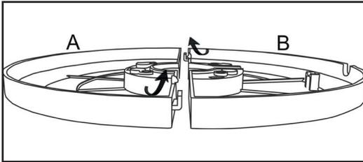
2. Drehen Sie das Gerät auf den Kopf und führen Sie das Netzkabel durch die mittig liegende Öffnung im Standfuß. Verbinden Sie den Standfuß mit der restlichen Geräteeinheit.
