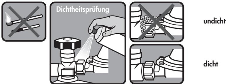
Abb. 2: Dichtheitsprüfung
