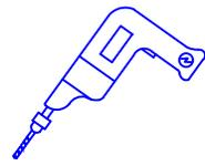
Planker forbores med 3mm bor max. 20mm dyb
